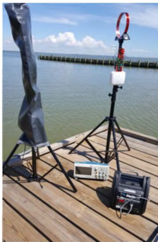
Рисунок 9 - Аппаратное исполнение системы тестирования методов МИ-связи: а) воздушное испытание, б) испытание в бассейне, в) морские испытания
