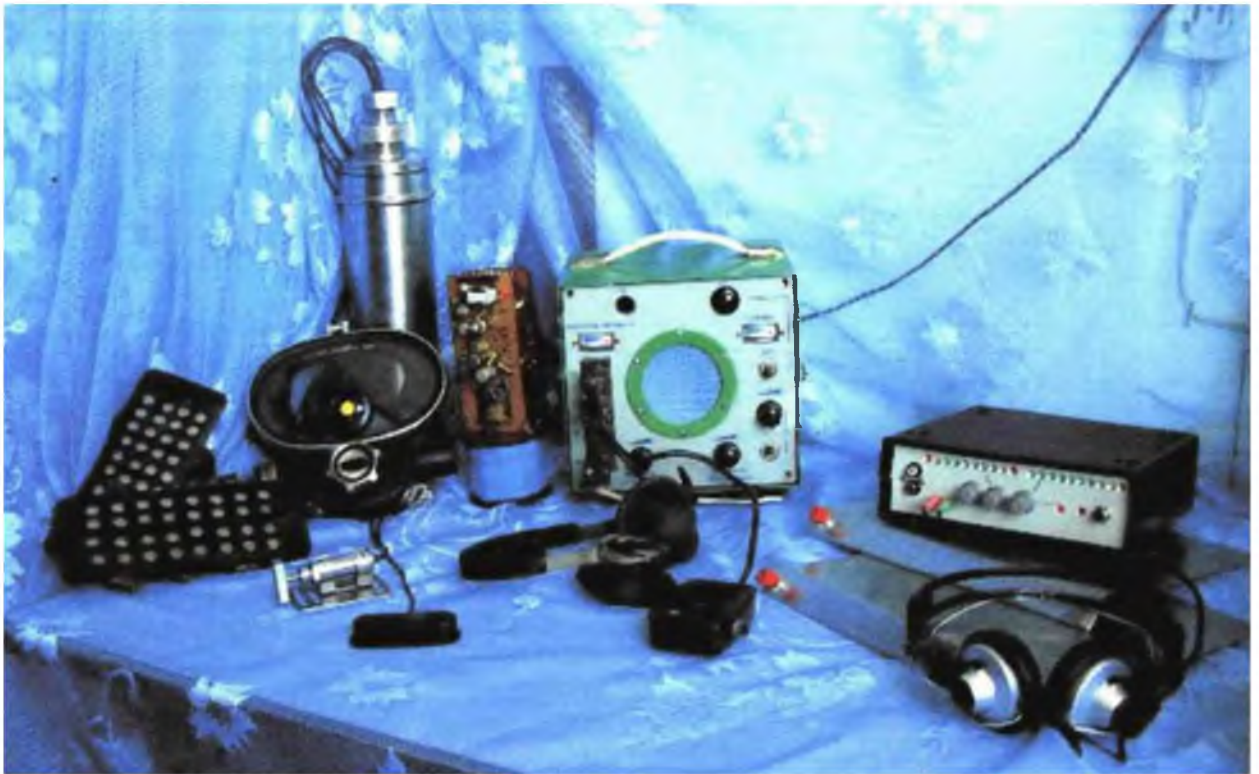
Рисунок 14 - Конструкция подводного переговорного устройства для легководолазов
