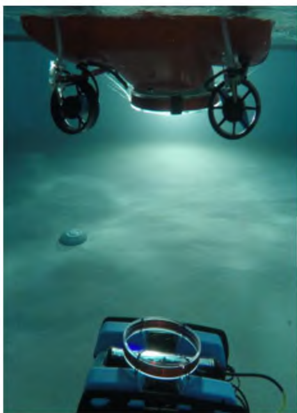
Рисунок 9 - Аппаратное исполнение системы тестирования методов МИ-связи: а) воздушное испытание, б) испытание в бассейне, в) морские испытания
