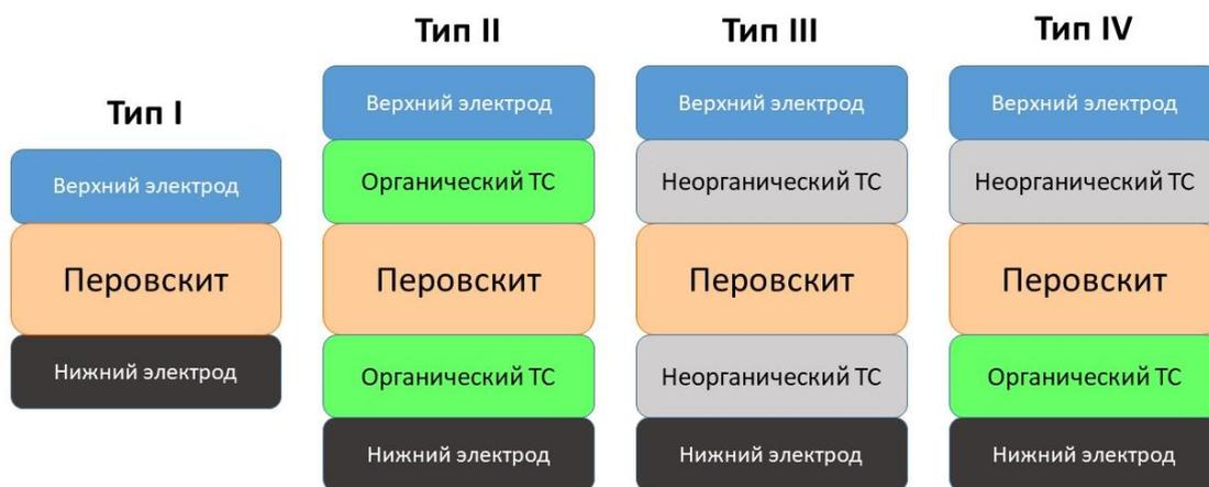
Рисунок 15 – Схематичное представление типов структуры peroLED
