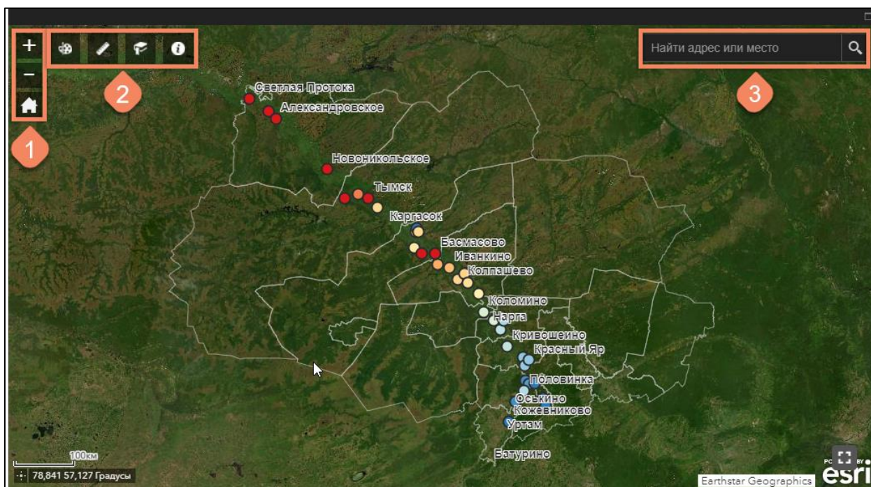
Рисунок 61 — Область карты с виджетами (1 — инструменты навигации; 2 — набор инструментов (слева направо): «Рисование», «Линейка», «Закладки», «Описание»; 3 — строка поиска по карте
