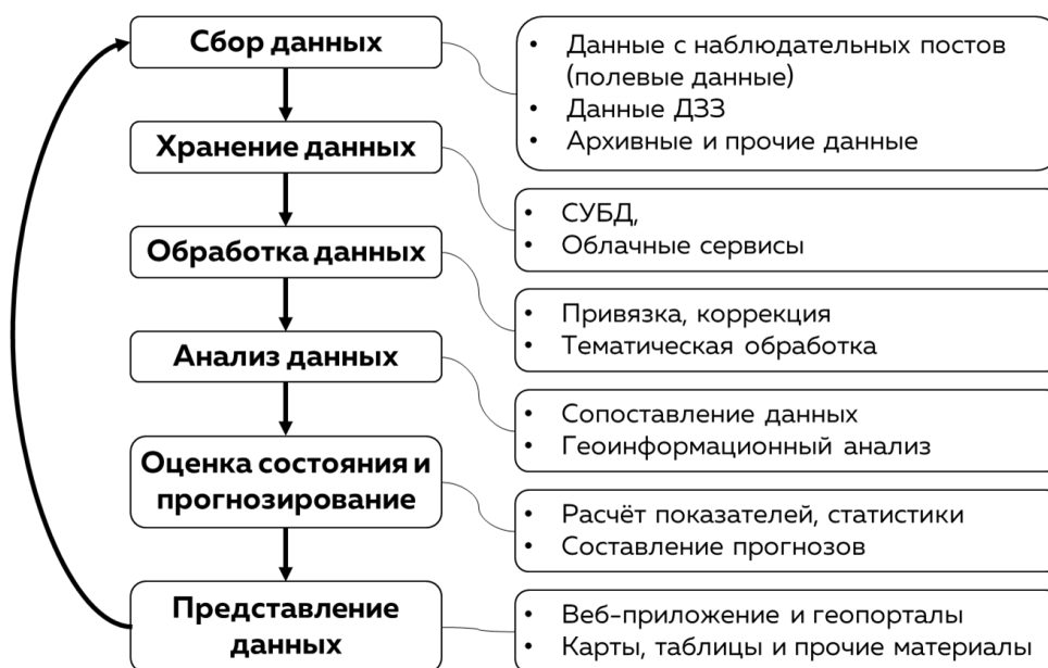
Рисунок 30 — Принципиальная схема геоинформационного мониторинга
