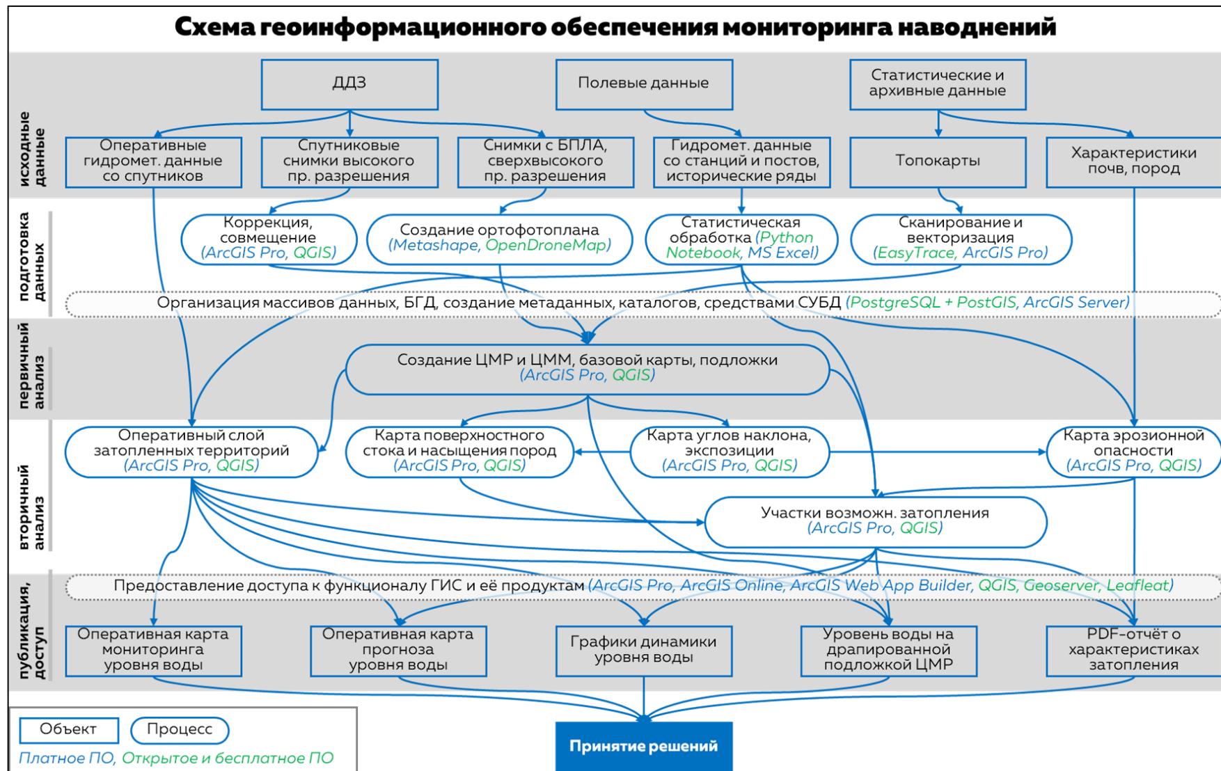
Рисунок 31 — Гипотетическая схема геоинформационного обеспечения мониторинга наводнений для поддержки принятия решений
