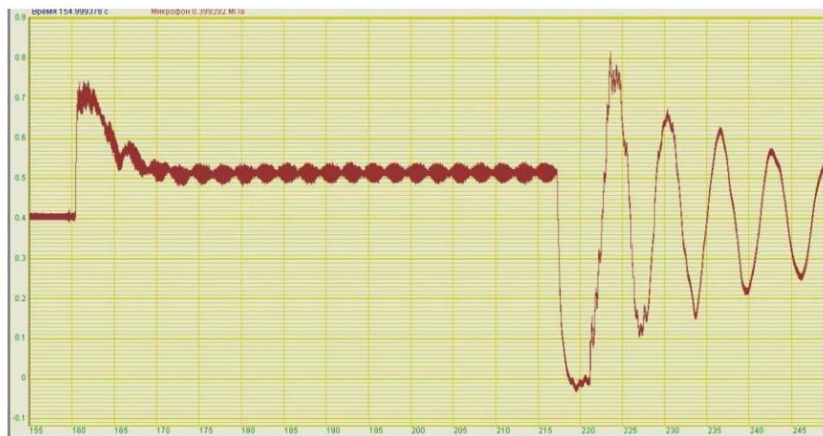
Рисунок 1.2 - Колебания давления при пуске насоса
