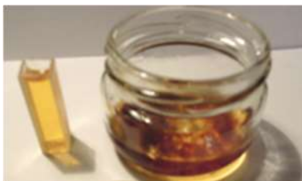
Рис. 2.8. Кювета с пробой жидкости, которая старилась в стеклянной бюксе в контакте с бумагой и медным катализатором
