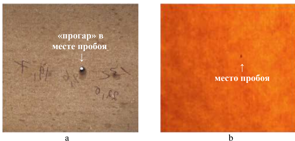
Рис. 2.3. Фото места пробоя: а - в случае образования «прогара» (пример); б – без образования «прогара» (при испытаниях опытных образцов ЭИБ из бамбука)
