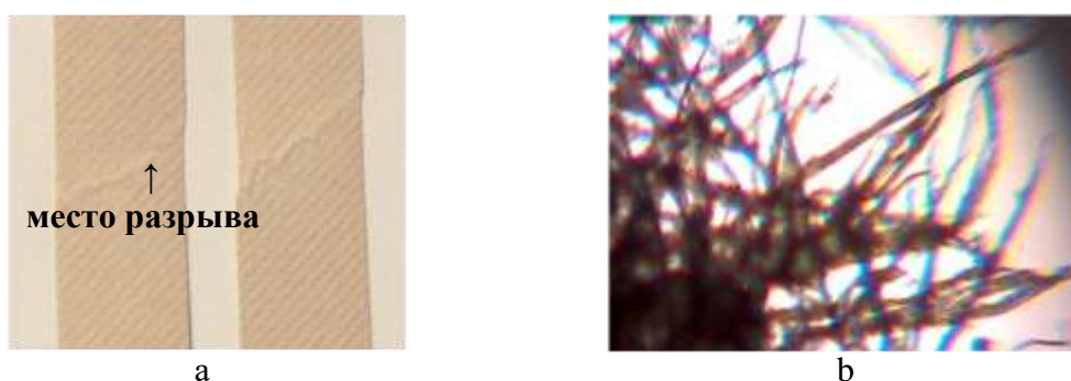
Рис. 2.5. а - фото места разрыва фрагмента ЭИБ; б – микрофотография (400х) состояния целлюлозных волокон в месте разрыва (после видимого разделения фрагмента ЭИБ на части)
