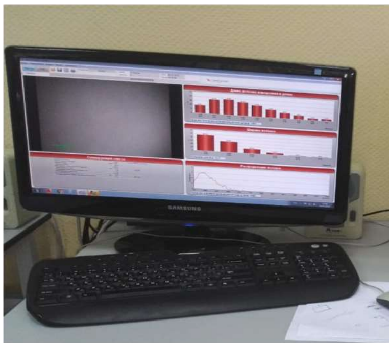
Рис. 2.11. Монитор ПК, сопряженного с анализатором волокон Fiber Tester, на экране которого формируется отчет о характеристиках волокон образца ЭИБ
