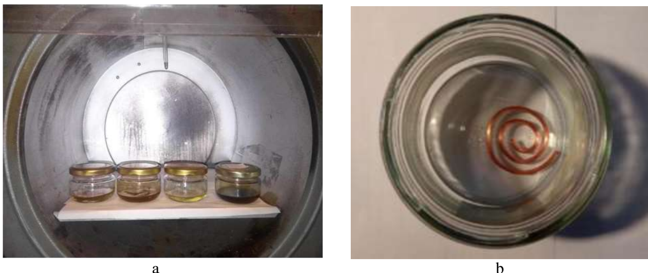
Рис. 2.6. а - термостат с бюксами; б – контрольный образец масла ГК с медным катализатором (спираль медного проводника) без бумаги
