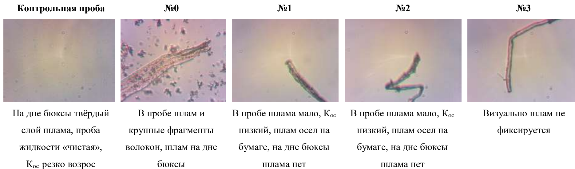
Рис. 3.10. Микрофотографии проб трансформаторного масла марки ГК после 330 часов термостарения в контакте с медным катализатором (контрольная проба), а также – с медью и образцами ЭИБ №0 - №3
