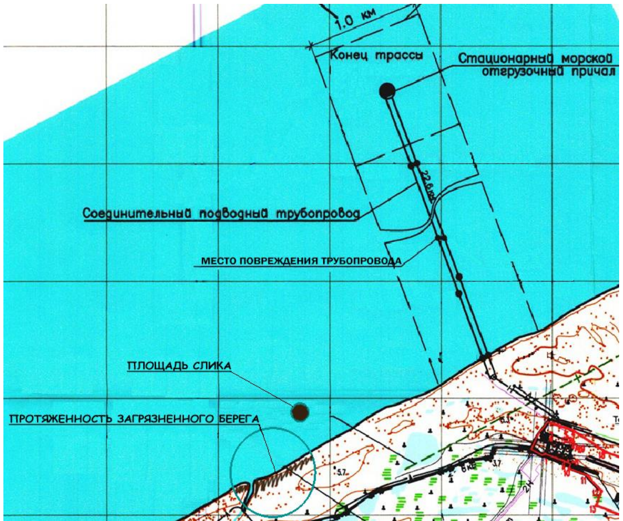
Рисунок 4.7 – Схема плана морского нефтеналивного порта Варандей с обозначением места повреждения трубопровода, площадью слика и протяженности загрязнения берега.
