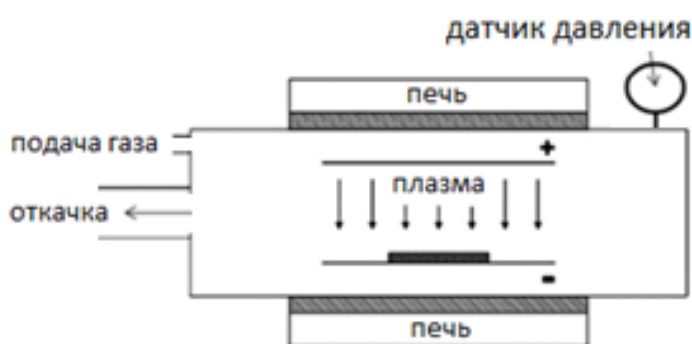
Рисунок 6 – Схема установки ПХОГФ в плазме разряда постоянного тока
