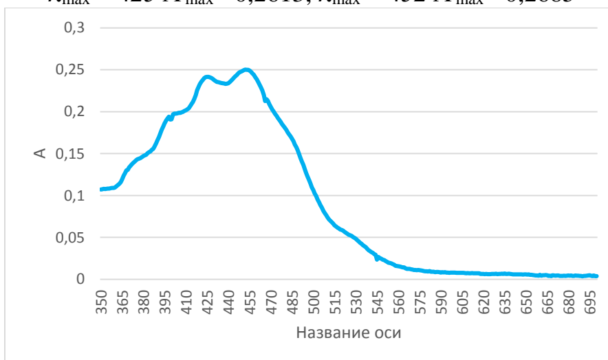
Рис. 91-93. Спектры ацетоновых экстрактов сухой биомассы штамма FZPM (F) 7.2.1, культивируемой в колбе Б без лимонной кислоты в течение 4 суток в 3 параллелях
