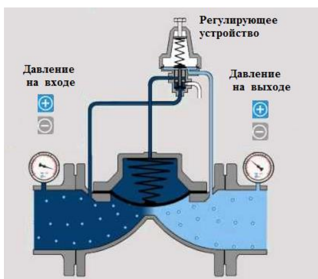
Рис.1.2. Схема редукционного клапана
