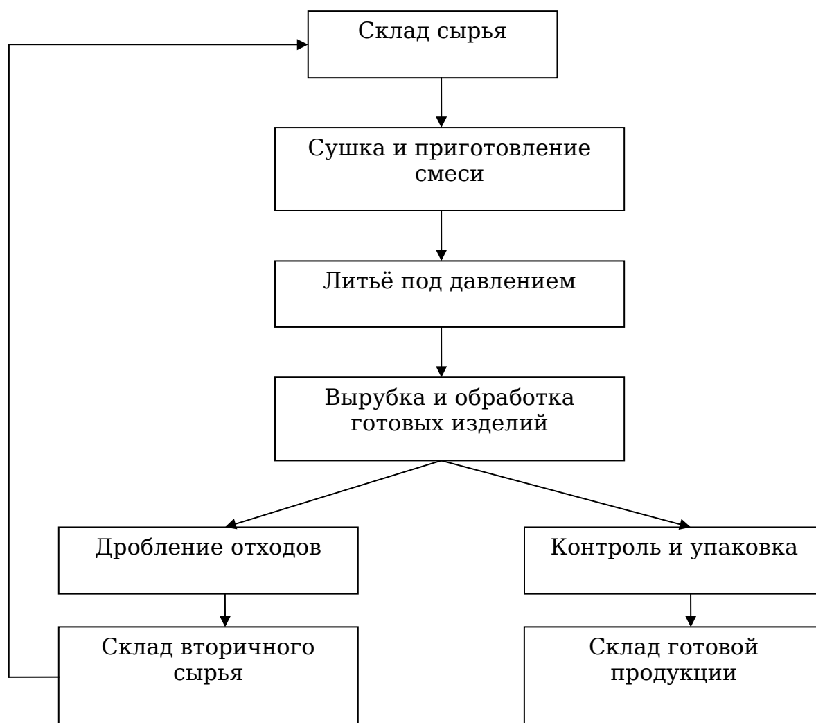
Рис. 2. Технологический процесс жидкофазного литья 1
