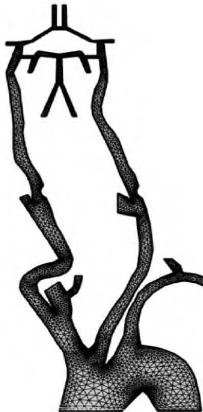
Рис.4.6. компьютерная геометрическая модель БЦА с ВК при сужении на 30% обеих ВСА.
