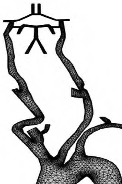
Рис.4.3. компьютерная геометрическая модель БЦА с ВК при сужении на 30%.
