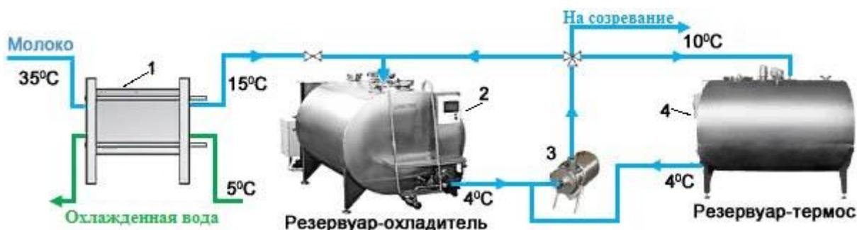
Рисунок 10– Комбинированная схема охлаждения молока в резервуаре-охладителе с предварительным теплообменником
