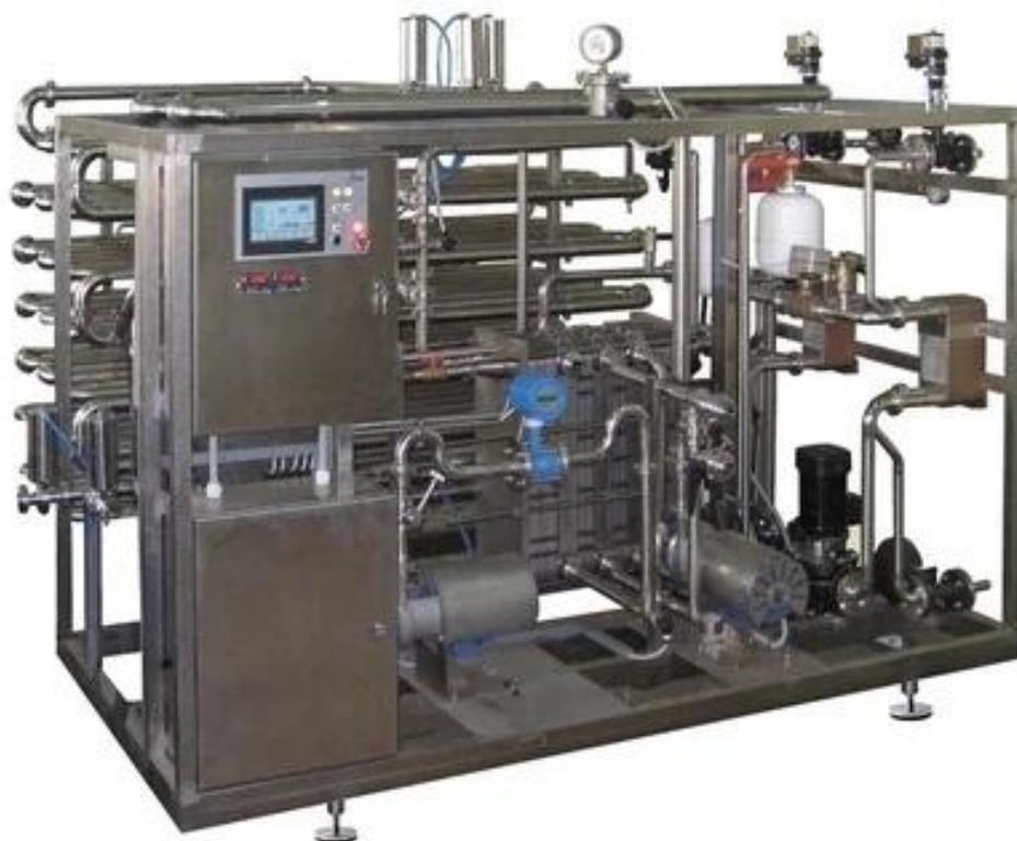
Рисунок 4 –Пластинчатая пастеризационно-охладительная установка А1-ОКЛ-2 производительностью 2 м<sup>3</sup>/ч (ППОУ)
