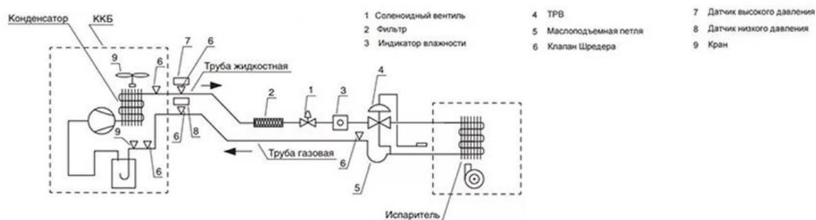
Рисунок 25 – Принципиальная схема работы ККБ и перечень входящего оборудования
