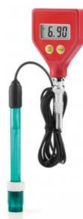
Рисунок 2.5 - рН метр с выносным пластиковым электродом РН98105
