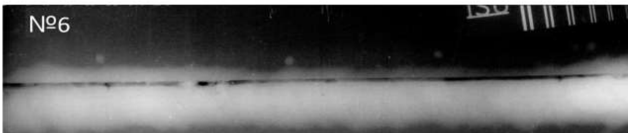
Рисунок 4.3. Образцы № 5 - 6. Сварка пятого и шестого образца производилась без ветра, под углом наклона горелки: 5)60° 6)30°, порошковой проволокой 1,2 мм в газовой защите CO 2 с расходом 12 л/мин.
