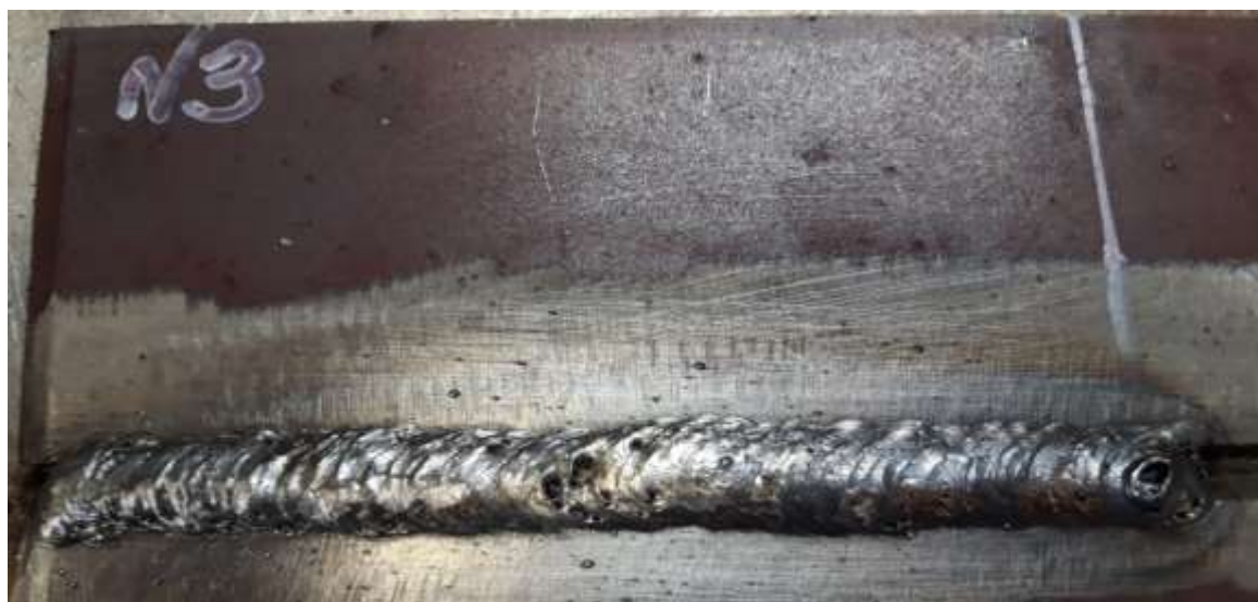
Рисунок 3.11. Облицовочный проход образца №3
