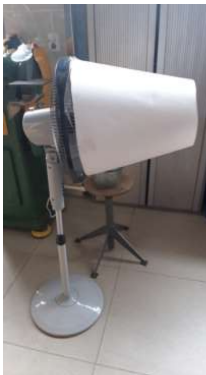
Рисунок 3.5. Установка для подачи ветра
