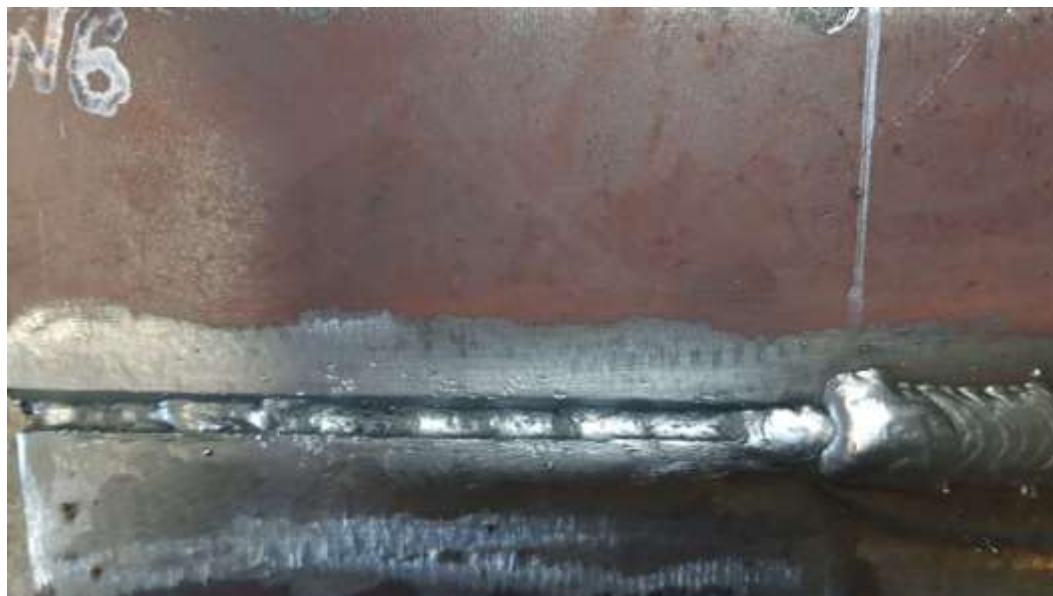
Рисунок 3.16. Корневой проход образца №6
