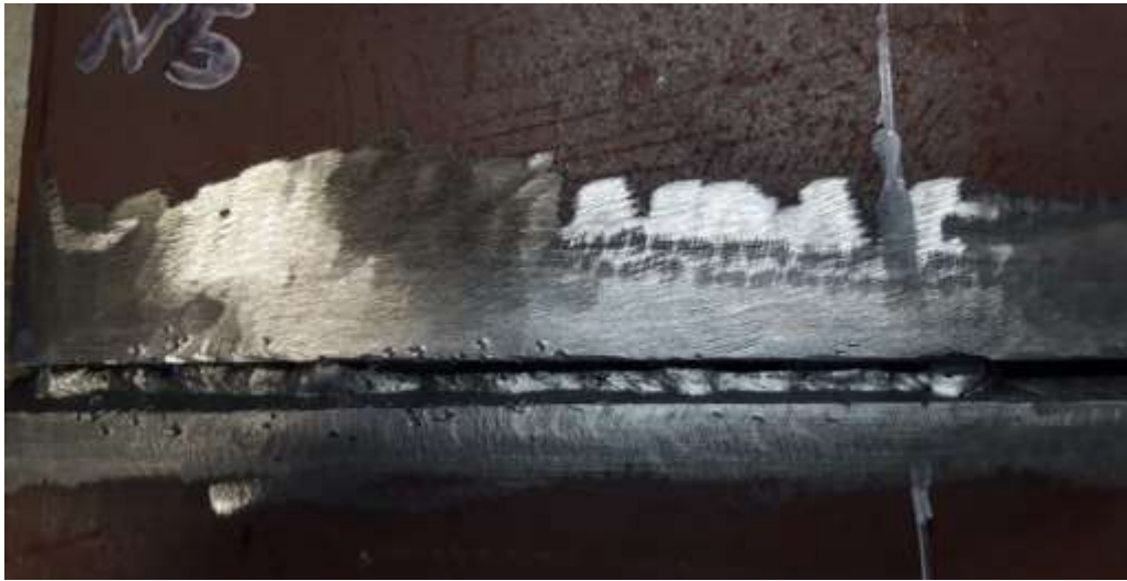
Рисунок 3.14. Корневой проход образца №5
