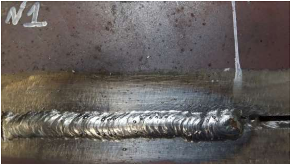
Рисунок 3.7. Облицовочный проход образца №1
