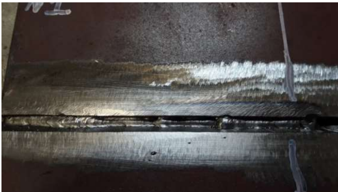
Рисунок 3.6. Корневой проход образца №1
