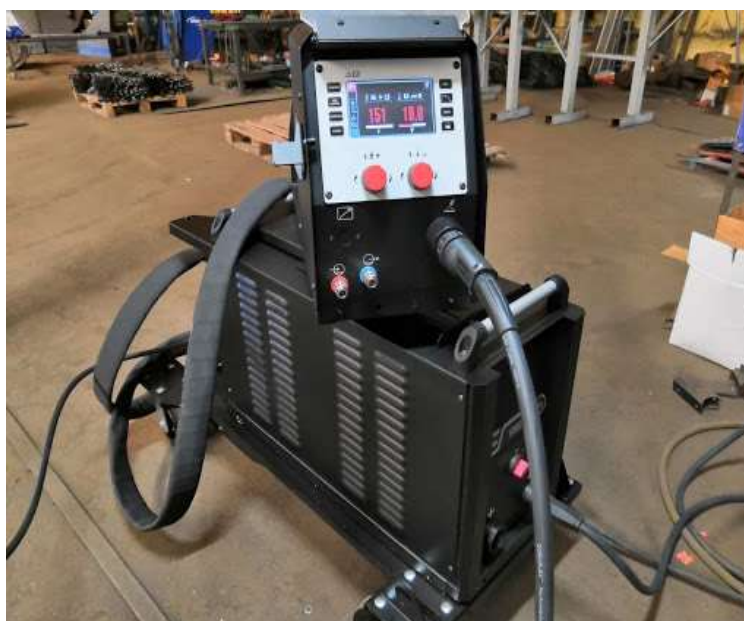
Рисунок 3.3. Сварочного полуавтомата EvoMigBasic 350
