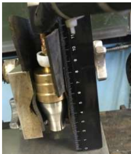
Рисунок 2.4. Выполнение наплавки при различных углах наклона горелки
