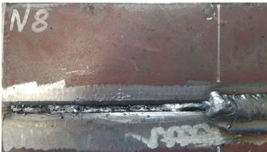
Рисунок 3.20. Корневой проход образца №8
