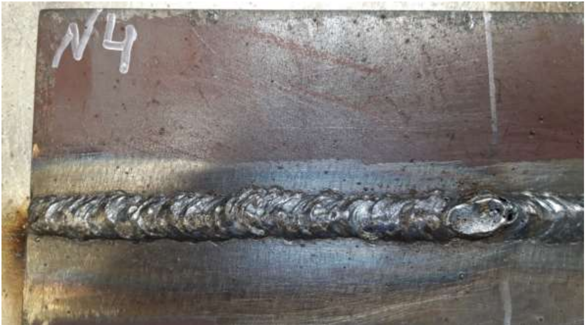
Рисунок 3.13. Облицовочный проход образца №4
