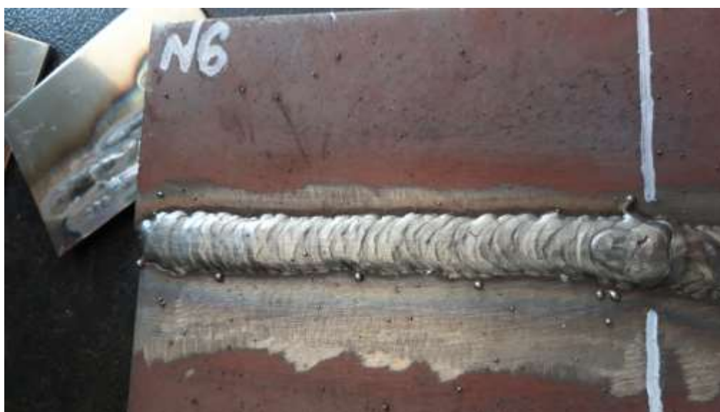
Рисунок 3.17. Облицовочный проход образца №6
