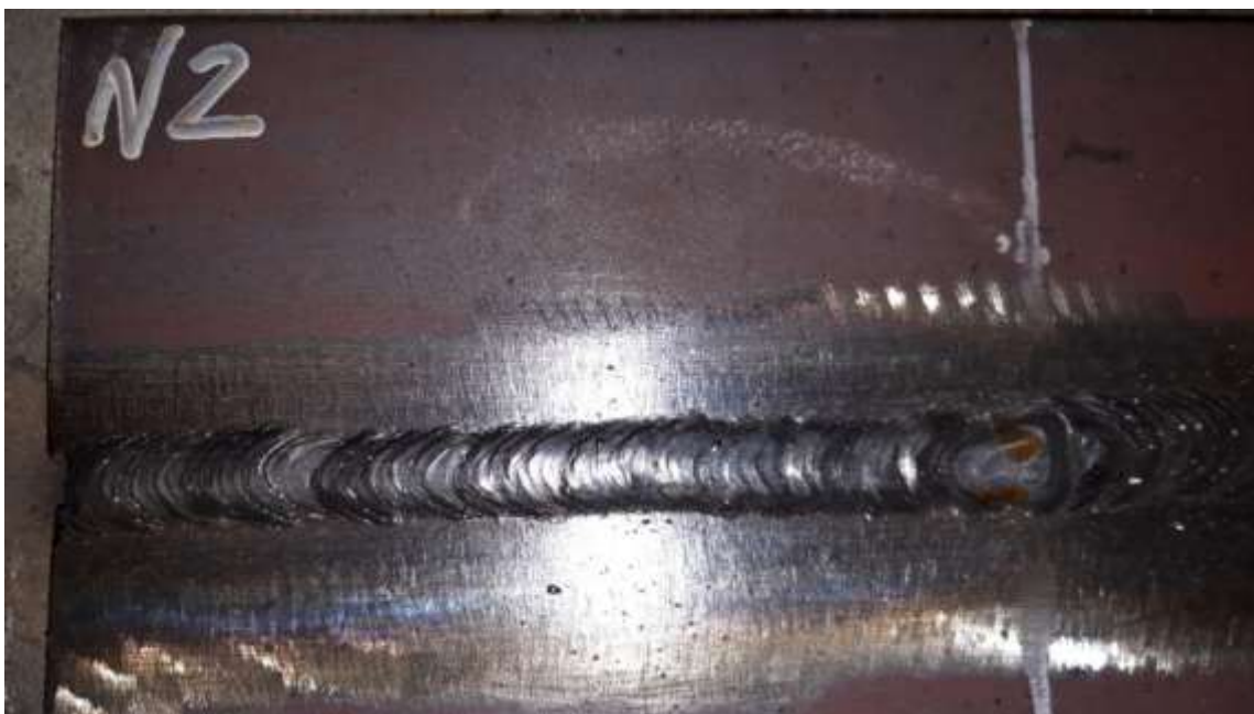
Рисунок 3.9. Облицовочный проход образца №2
