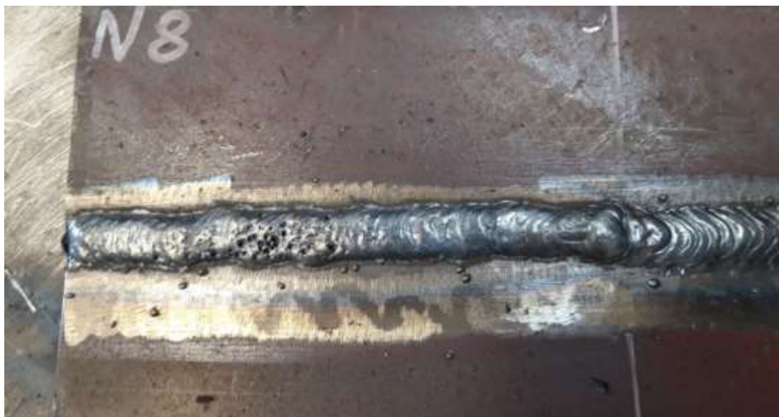
Рисунок 3.21. Облицовочный проход образца №8
