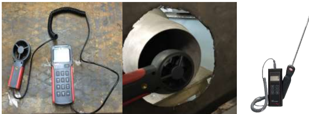
Рисунок 2.6. Измерение скорости ветра термоанемометром
