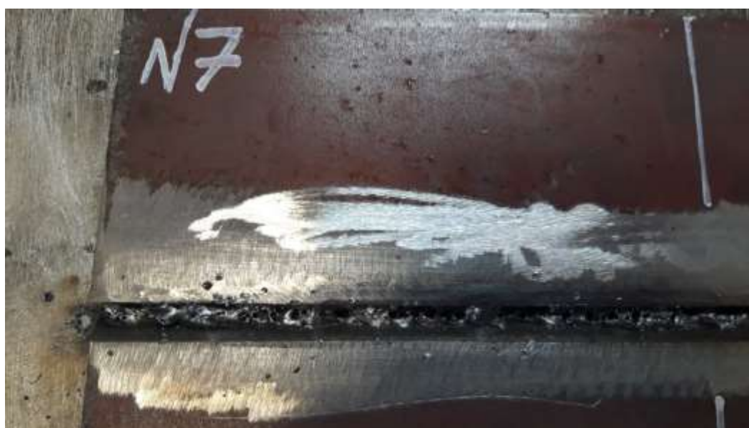
Рисунок 3.18. Корневой проход образца №7
