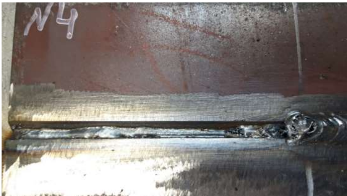
Рисунок 3.12. Корневой проход образца №4
