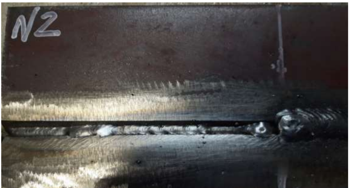
Рисунок 3.8. Корневой проход образца №2
