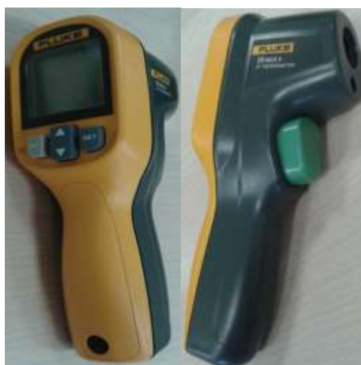
Рисунок 2.7. Измерение тепловых полей пирометром «Флюке»
