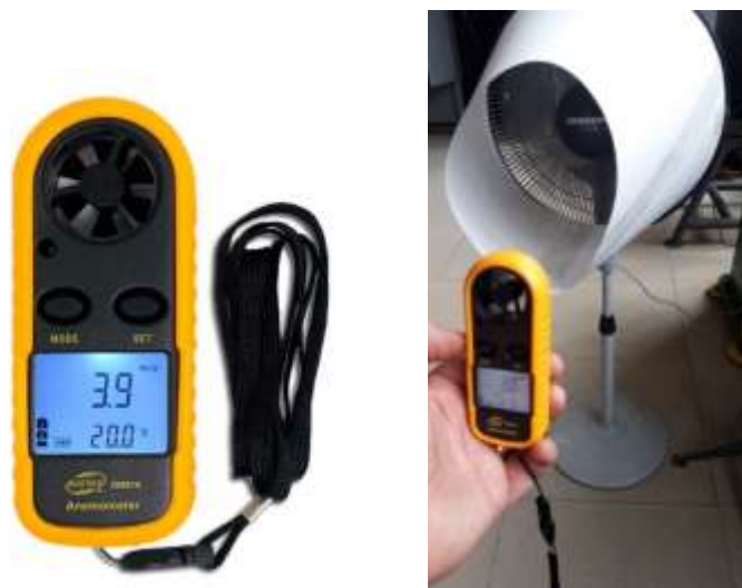
Рисунок 3.4. Анемометр Venetech GM816
