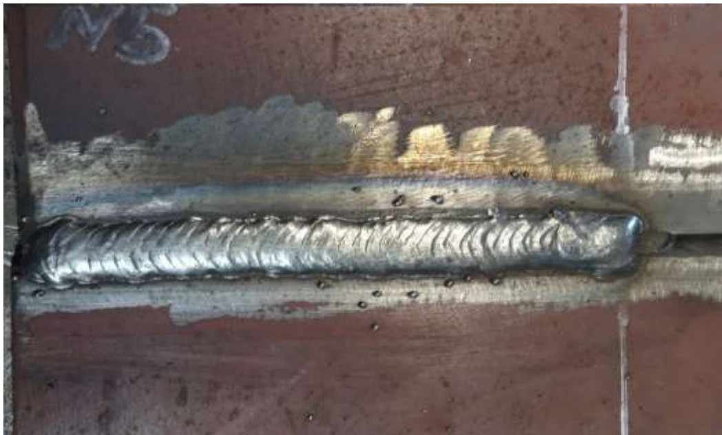
Рисунок 3.15. Облицовочный проход образца №5
