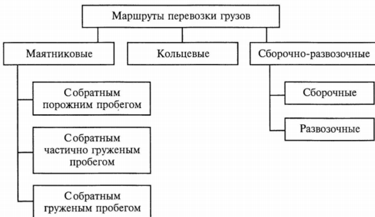
Рис. 1.4 - Классификация маршрутов для перевозки грузов
