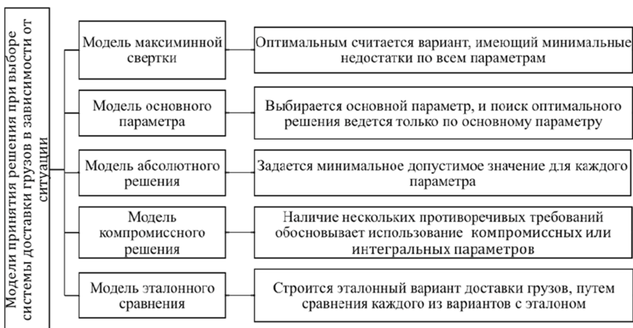
Рис. 1.1 – Структурная схема моделей принятия решений при выборе системы доставки грузов
