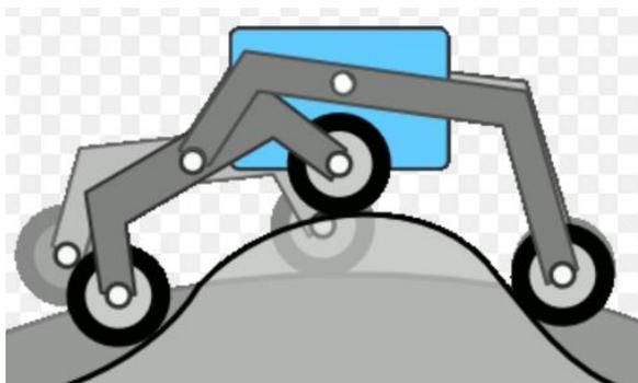
Рисунок 47 - Принцип работы подвески «рокер-тележка»
