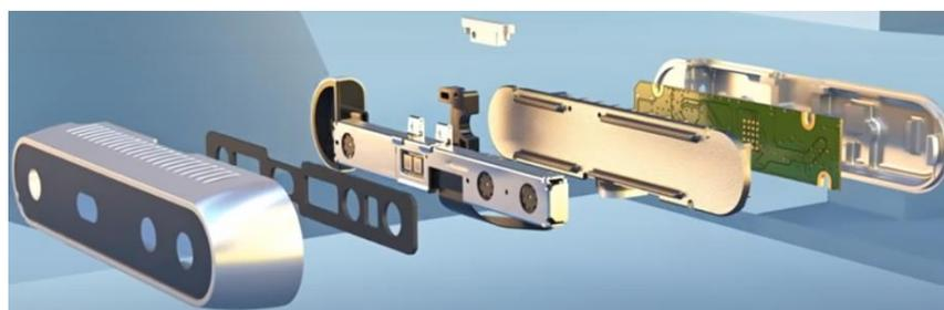
Рисунок 30 - Камера Intel RealSense D415
