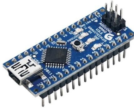
Рисунок 17 - Arduino Nano
