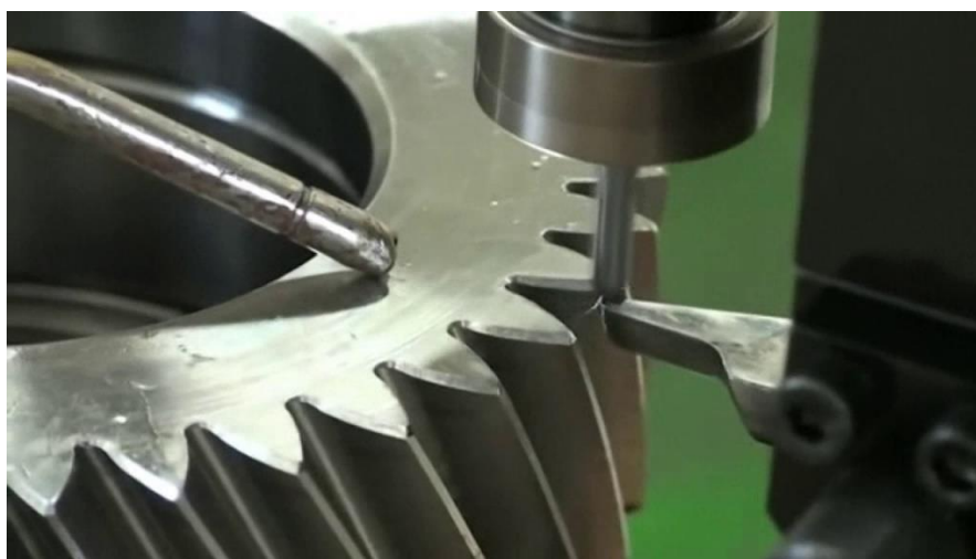
Рис 1. – Процесс обработки торца зубчатого колеса
