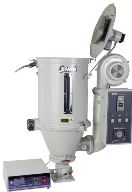
Рисунок 2.1 – Бункер-сушилка SHINI SHD-25 оснащенная ультразвуковым аппаратом
