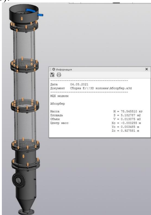
Рисунок 3.6 – Масса колонны абсорбции по 3D – модели
