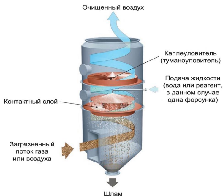
Рисунок 4.3. Принципиальная схема газоочистного аппарата вихревого действия
