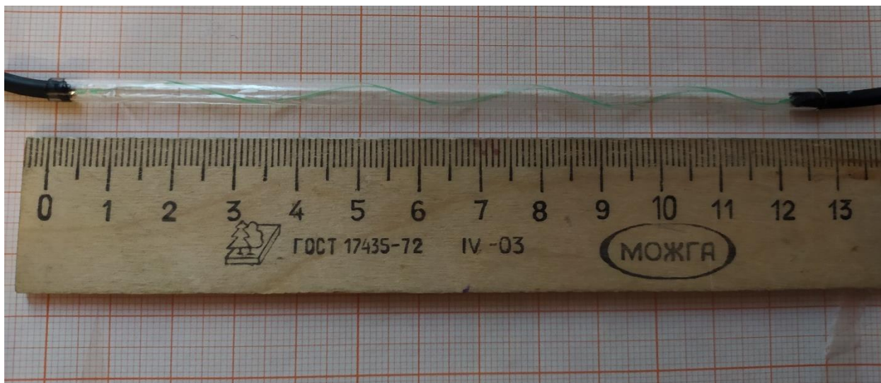
Рис. 2.8 – Измерение шага геликоида
