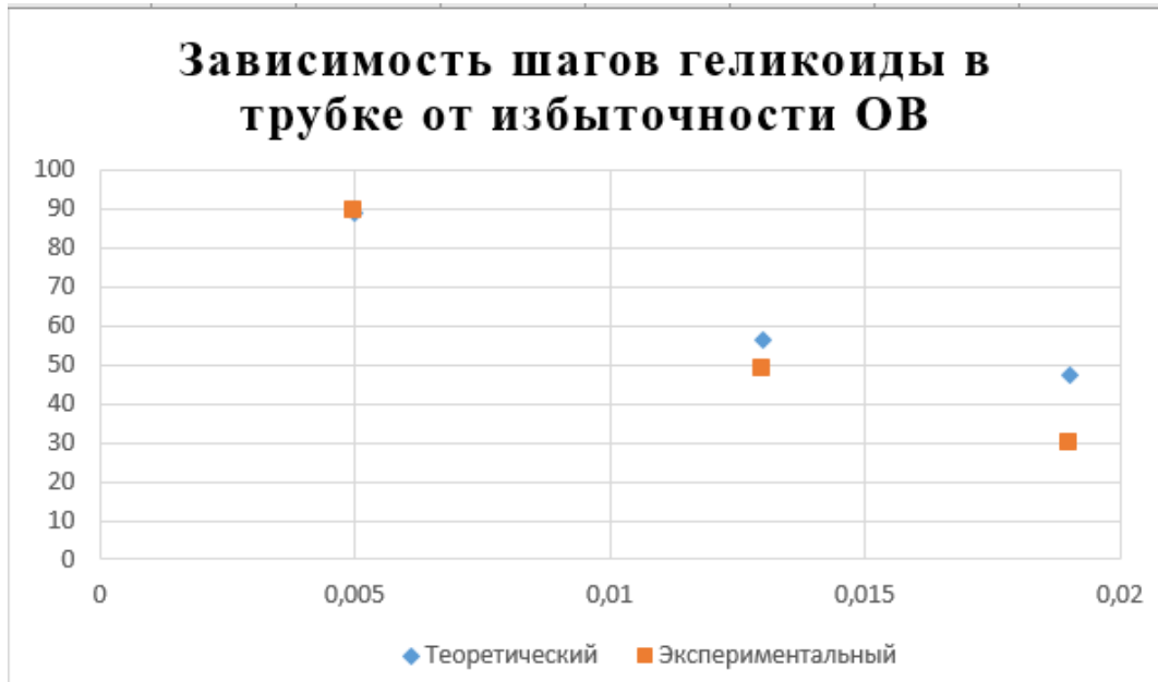
Рис. 2.24 – График зависимости шага геликоиды от ИД для первой трубки
