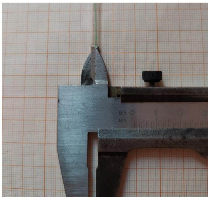
Рис. 2.3 – Измерение диаметра трубки
