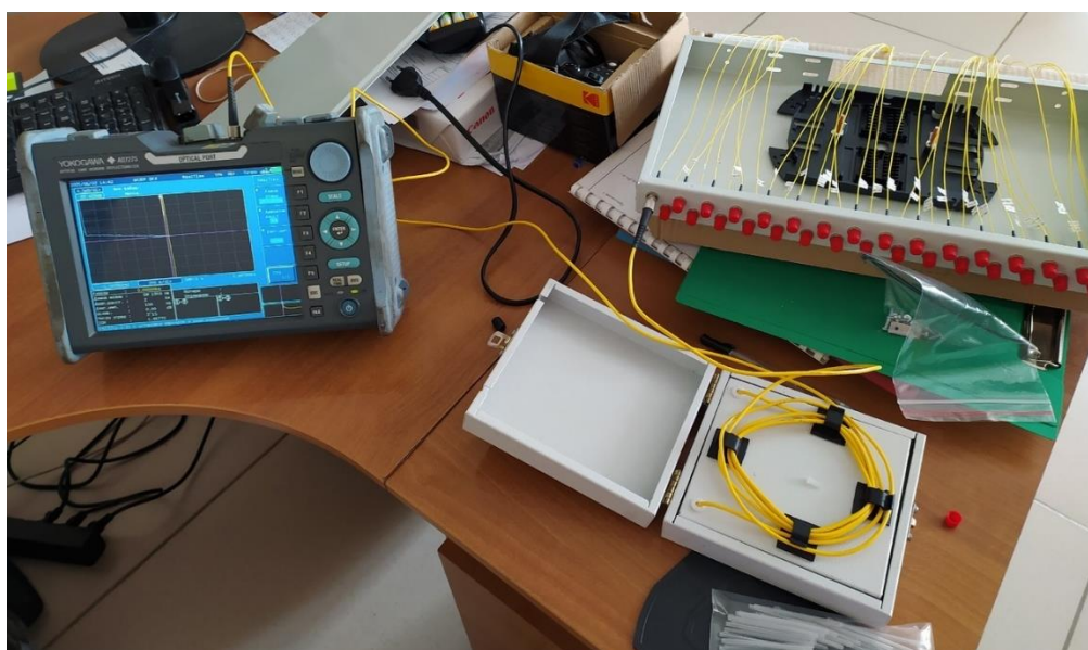
Рис. 3.6 – Макет для измерения затуханий в волокне
