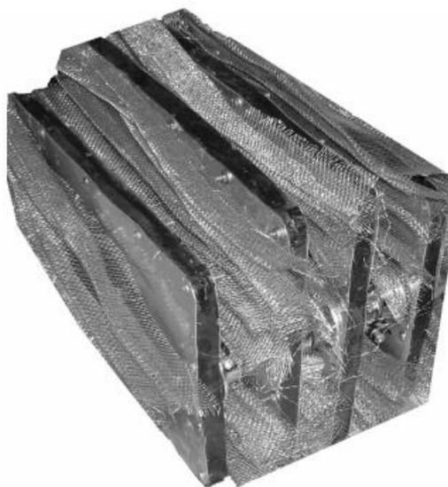
Рисунок 6.1 – Контактное устройство для колонны.
