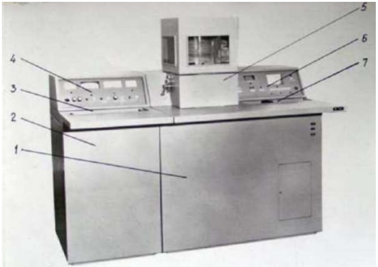
Рисунок 8 - Вид установки ВУП-4:1–вакуумная стойка; 2–электрическая стойка; 5–столик вакуумного препарирования; 3,4,6,7–пульты управления.
