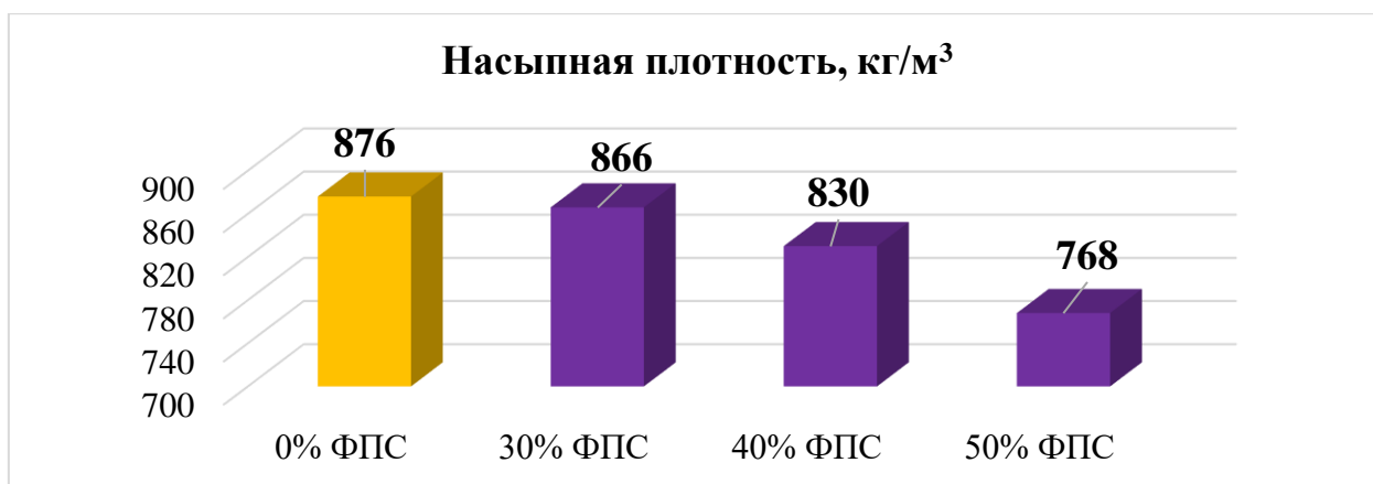
Рисунок 3.4 - Зависимость насыпной плотности сухой гипсовой смеси от количества вводимой добавки ФПС
