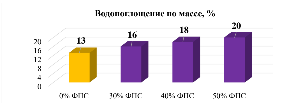
Рисунок 3.11 – Зависимость водопоглощения затвердевшего гипсового раствора от количества вводимой добавки ФПС
