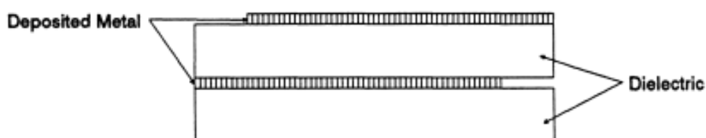
Рис. 5. Металлизация на диэлектрике [9].
