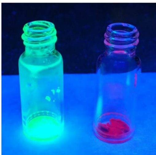
Рисунок 3.29 – Фото образцов pNC/TEOS под УФ лампой на основе ПНК химического состава - \text{CsPbBr}_3 (слева) и \text{CsPb}(\text{Br/I})_3 (справа) - после хранения при нормальных условиях в течение 1 недели.
