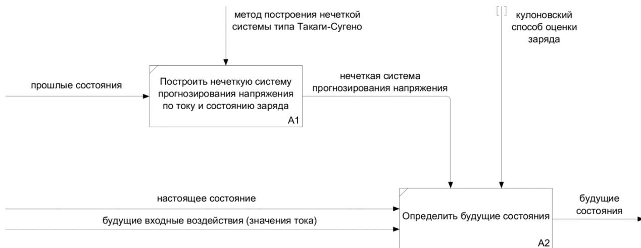
Рисунок 2.3. Декомпозиция постановки задачи прогнозирования состояния при её решении методом пространства состояний
