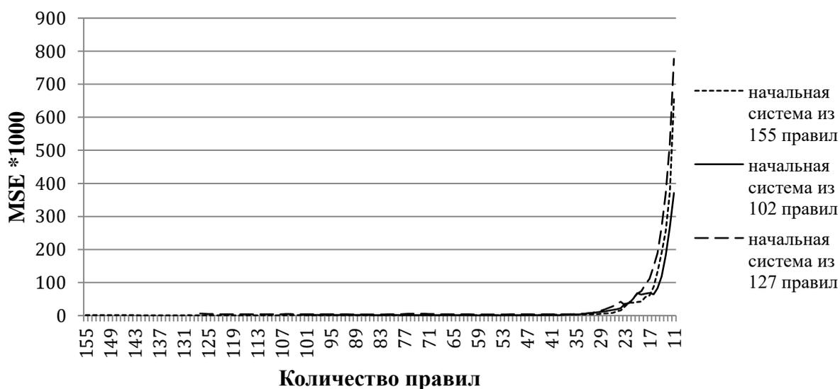
Рисунок 4.4. Зависимость среднеквадратичной ошибки нечеткой системы для прогнозирования состояния заряда от количества правил для обучающей выборки
