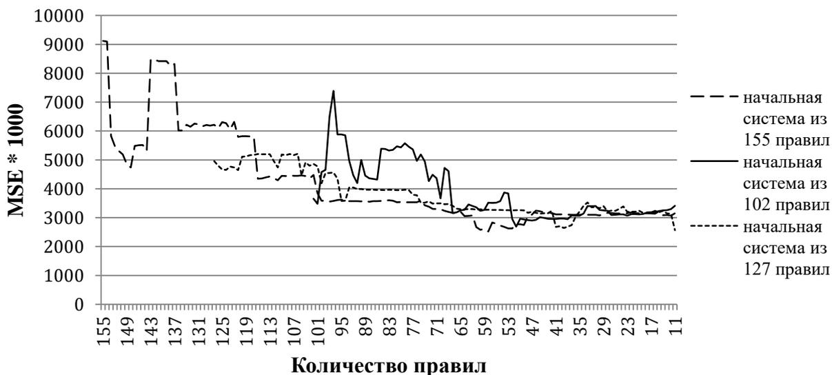
Рисунок 4.5. Зависимость среднеквадратичной ошибки нечеткой системы для прогнозирования состояния заряда от количества правил для тестовой выборки
