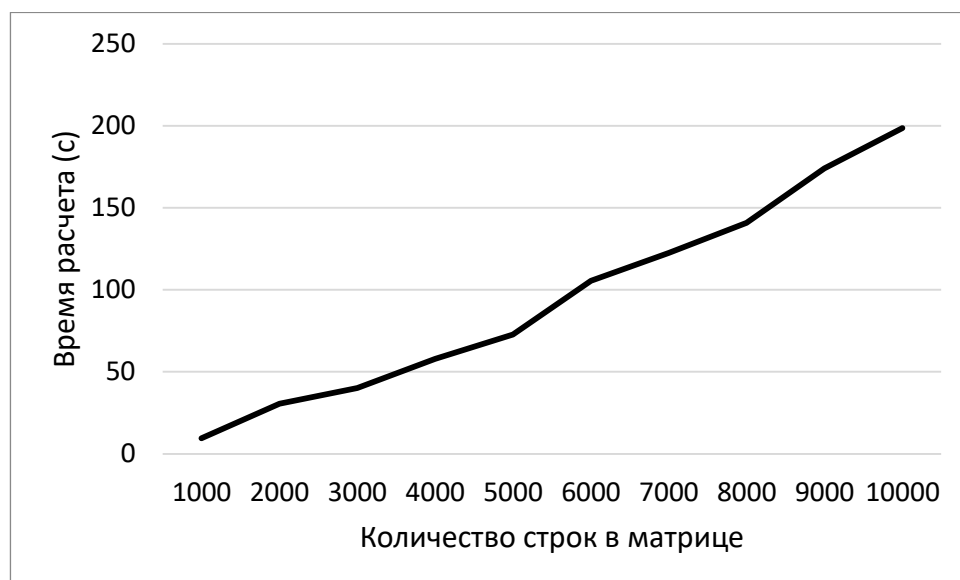
Рисунок 4.3 – Зависимость времени расчета параметров \theta от количества строк в матрице выборки. Количество атрибутов зафиксировано и равно 6.
