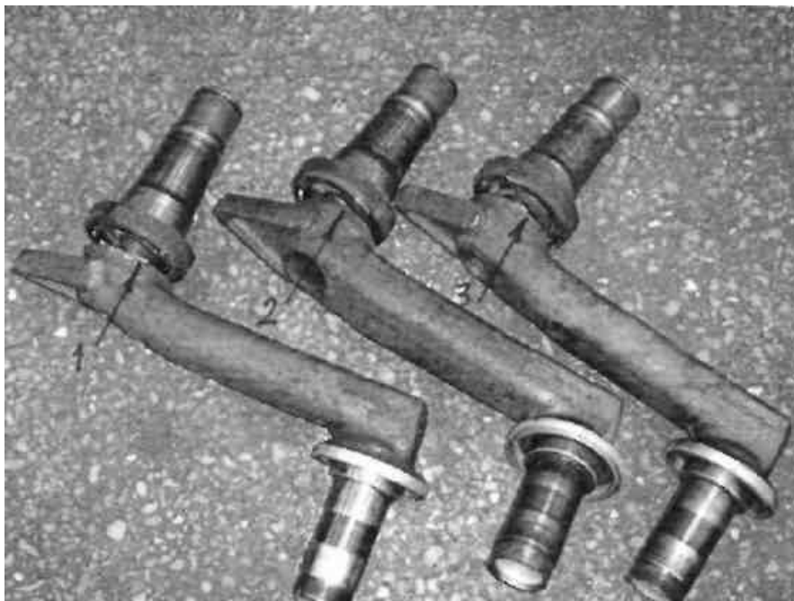
Рисунок 34- поврежденные балансиры БГМ
