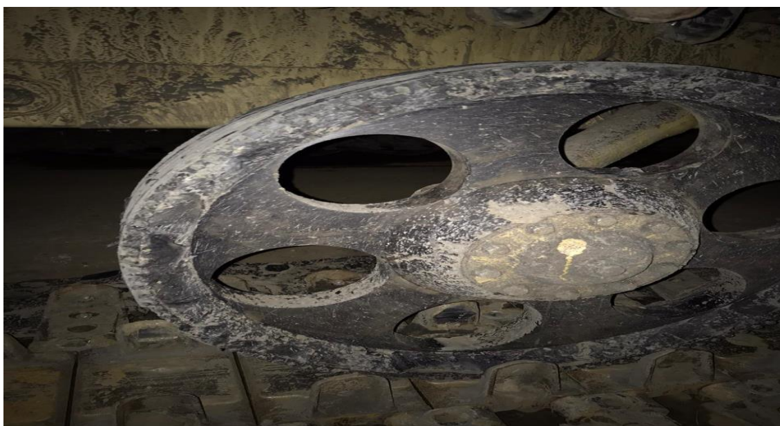
Рисунок 32- Разрушенный экспериментальный опорный каток из композитного материала снегоболотохода ТМ-140
