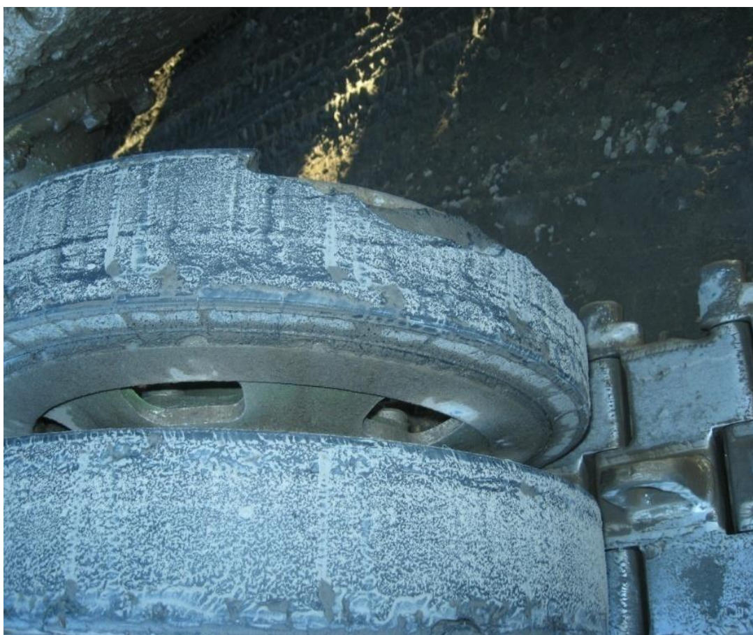
Рисунок 33- Каток БМД-4М с поврежденной массивной шиной
