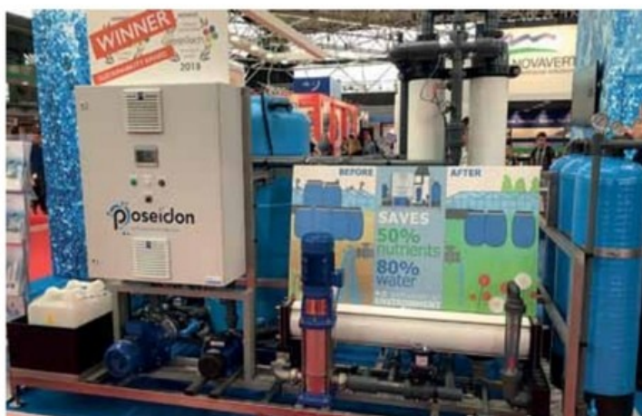
Рис. 2 – Небольшая фильтрационная система Poseidon Sodium Extractor (Van der Ende Group)
