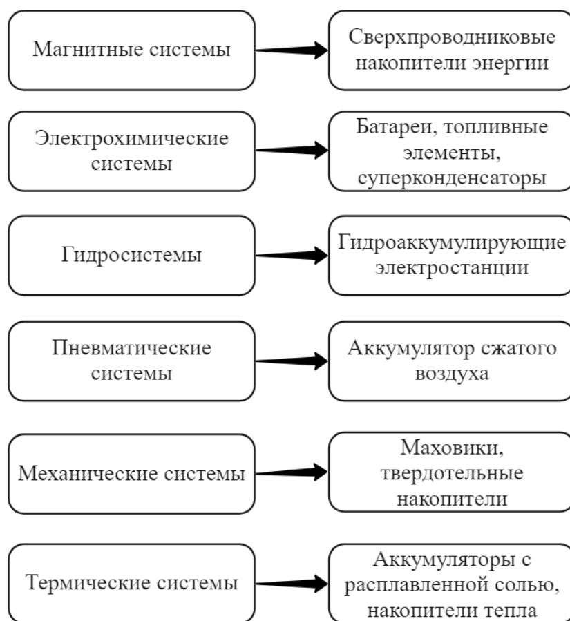
Рисунок 1.1 – Основные типы систем накопления энергии
