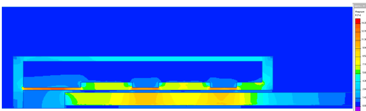
Рисунок 2.25 - Картина распределения магнитной индукции линейного электродвигателя
