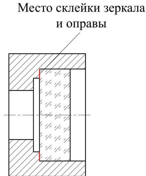
Рис. 3.17. Крепление оптического элемента в оправу с помощью клея.
