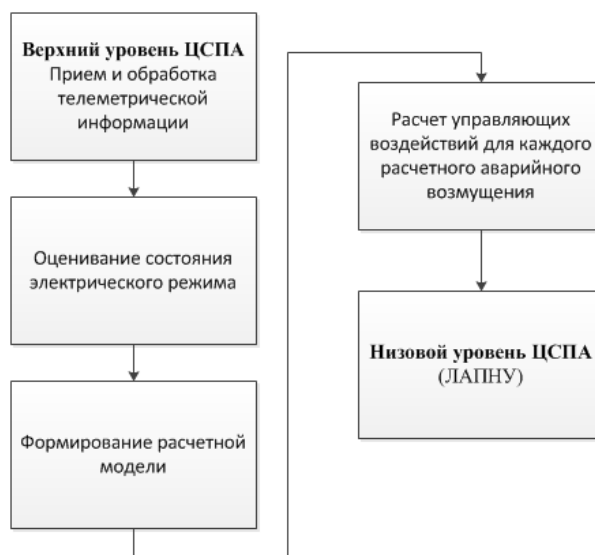
Рисунок 1- Упрощенная схема реализации работы ЦСПА
