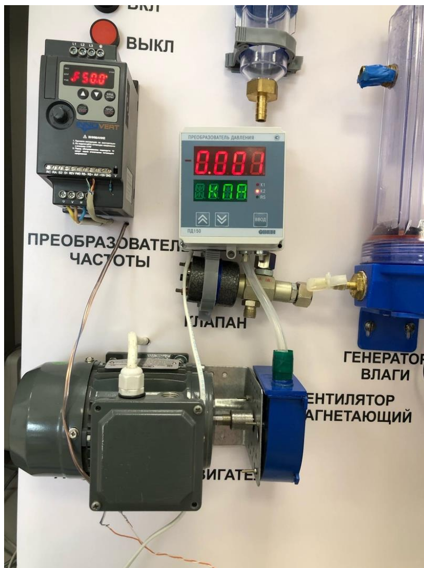
Рис. 3.5. Измерительный стенд для снятия характеристик вентилятора Полученные экспериментальные данные сведены в табл. 2.
