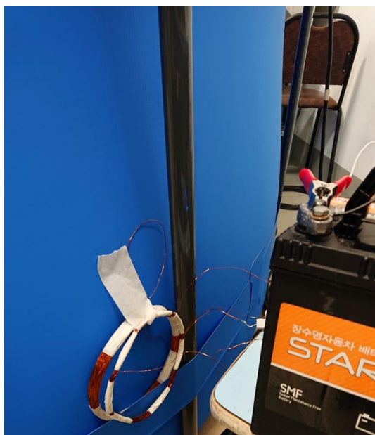
Рисунок 41 - Общий вид магнитной антенны №6: «с 117 витками»
