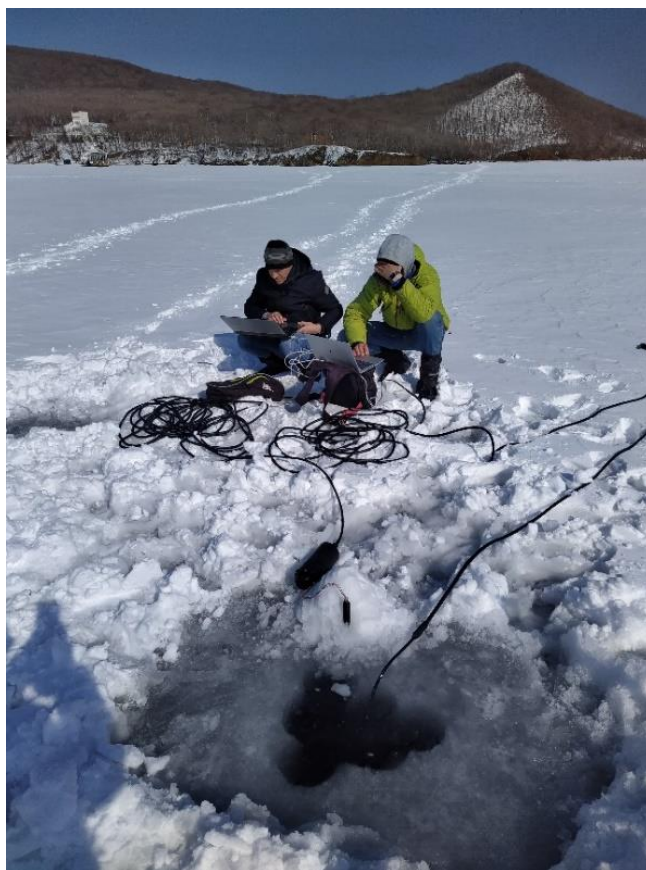
Рисунок 29 - Передатчик погружен в воду, приёмник не погружен
