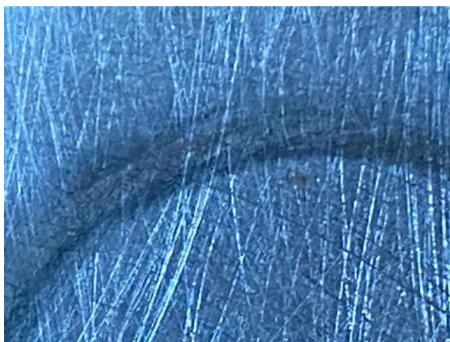
Рисунок 3.1.3.21 – Результаты исследования дорожки трения и продукта трибохимических реакций в паре трения сталь-сталь в присутствии смазочной композиции вазелиновое масло – продукты термолиза ацетата меди
