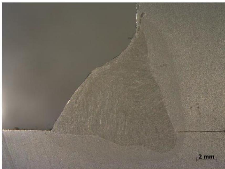
Рисунок 4.5 - Технология СМТ Twin позволяет сварщикам добиваться показательных результатов даже при сварке тавровых швов в положении РВ.
