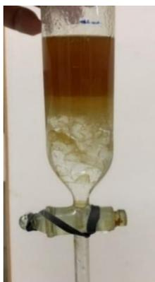
Рисунок 20 – Результат отмывки реакционной массы горячей водой
