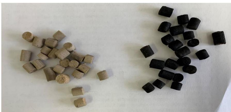
Рисунок 31 – Внешний вид свежего (слева) и отработанного (справа) катализатора
