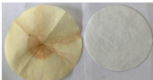
Рисунок 21 – Полимерная пленка, образовавшаяся на фильтре
