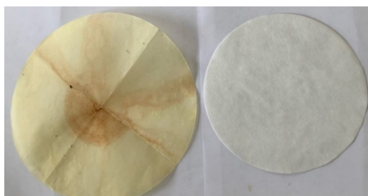
Рисунок 8 - Полимерная пленка, образовавшаяся на фильтре
