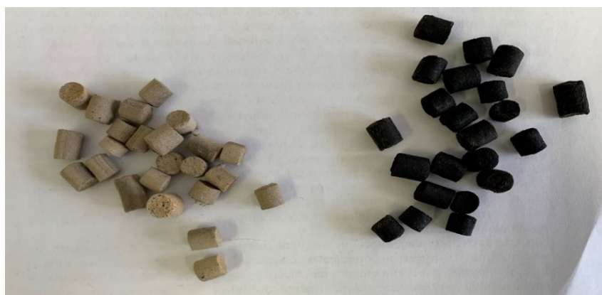
Рисунок 12 - Внешний вид свежего (слева) и отработанного (справа) катализатора
