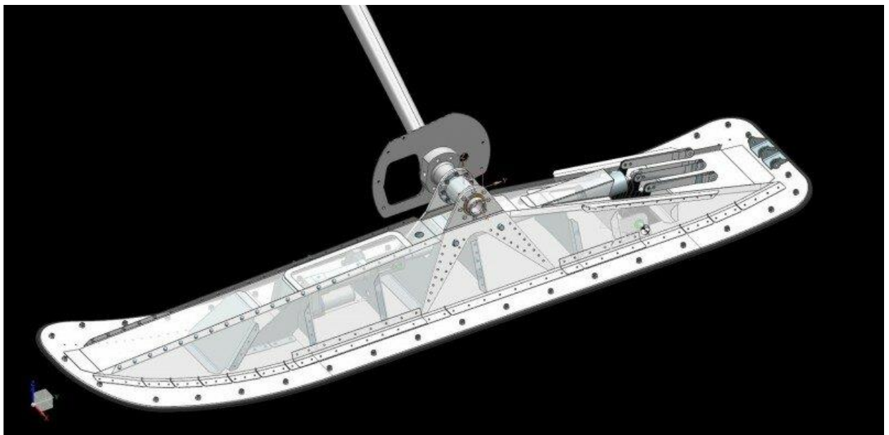
Рис. 3.4 – Амортизирующие взлетно-посадочные лыжи
