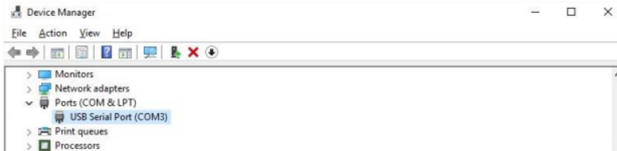
Рис. 23. Распознавание *FT232RL* как *COM*-порт после установки драйверов
