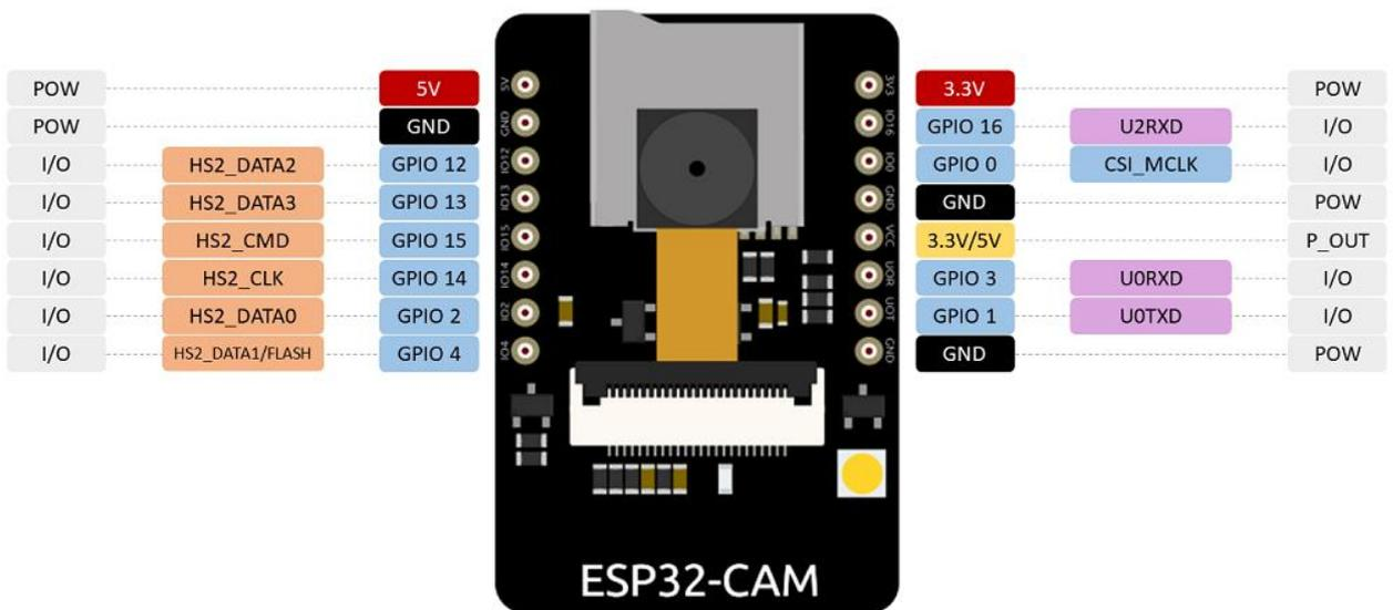
Рис. 14. ESP32-CAM
