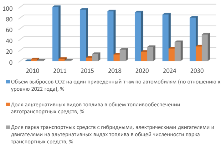
Рисунок 3 – Целевые значения индикаторов достижения цели снижения объемов выбросов от транспорта [выполнено автором на базе источника 17]
