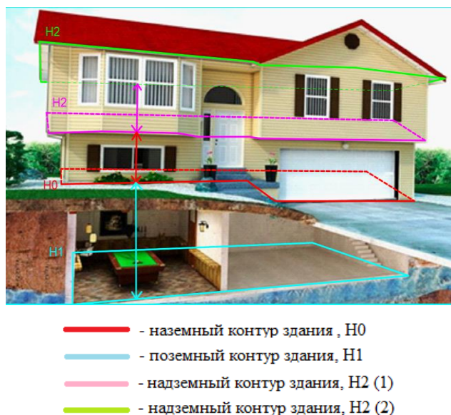
Рис. 3.2 – Контур здания ИЖС в 3D
