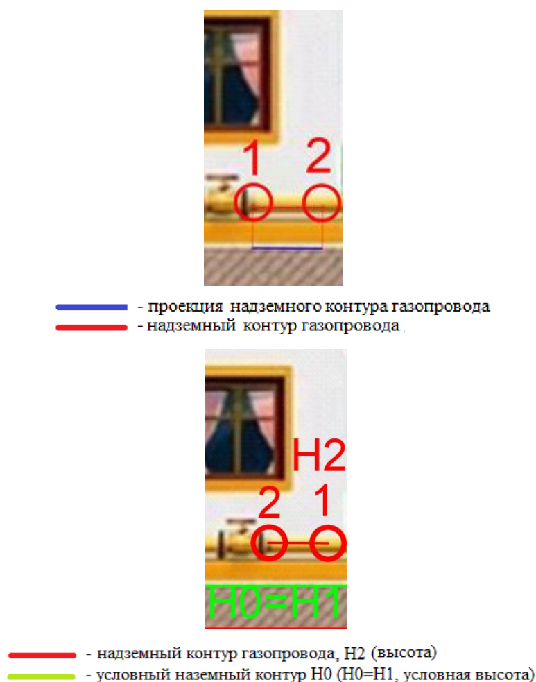
Рис. 3.15 – Схематичное сравнение построения надземного газопровода 2D от 3D
