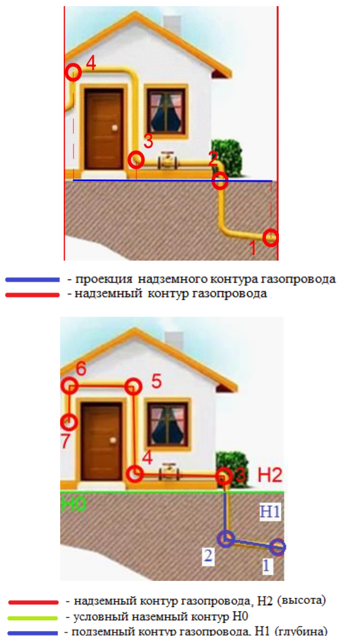
Рис. 3.17 – Схематичное сравнение построения газопровода 2D модели от 3D
