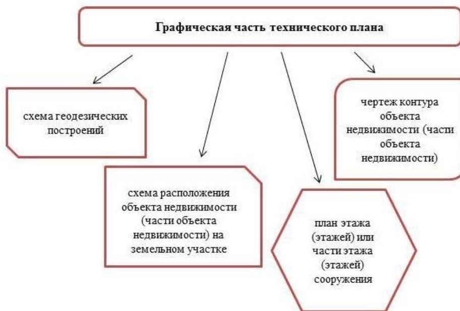
Рис. 2.7 – Графическая часть технического плана на сооружение
