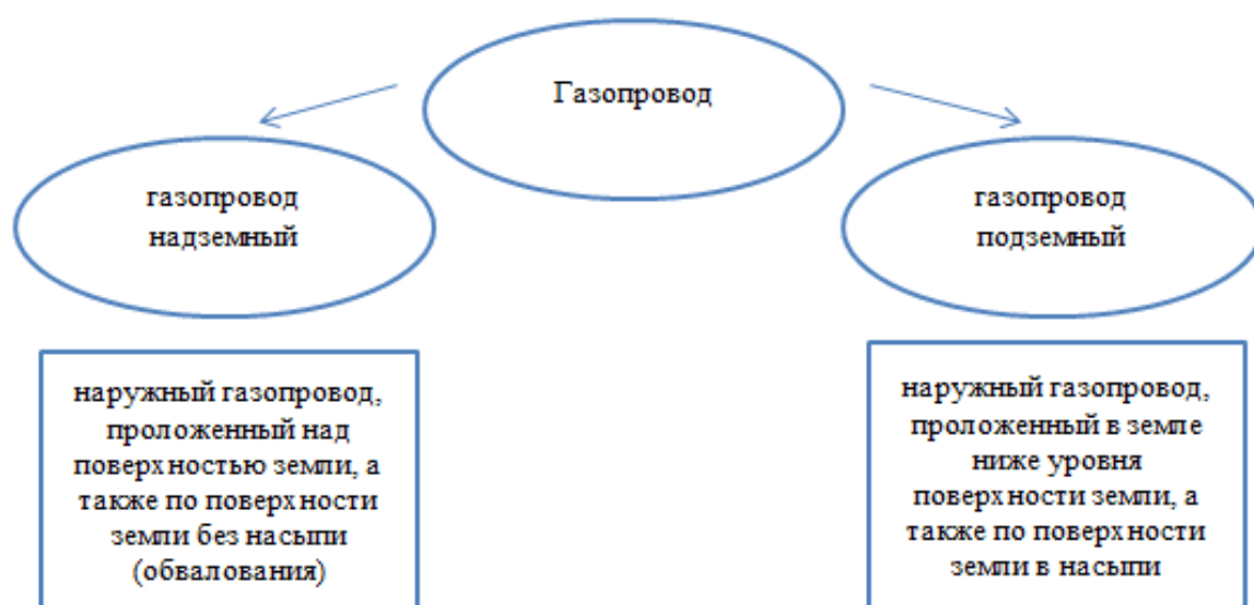
Рис. 3.10 – Виды газопроводов по их расположению в пространстве
