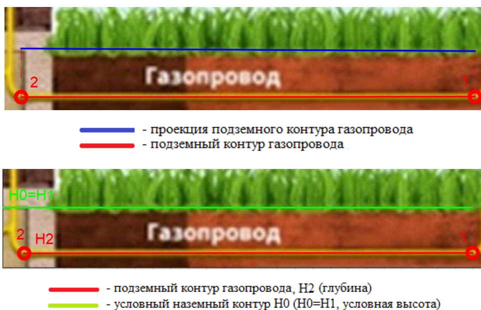
Рисунок 3.11 – Схематичное сравнение построения подземного газопровода в горизонтальной плоскости 2D от 3D
