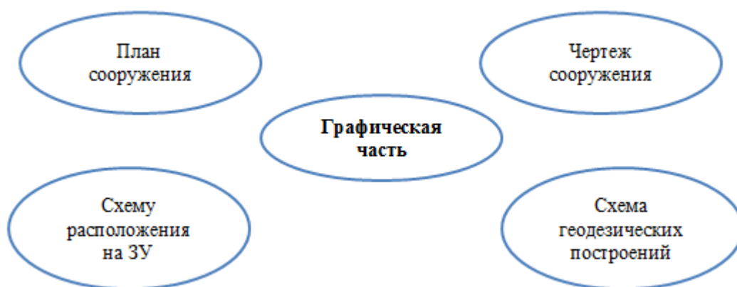
Рис. 4.19 – Содержание графической части на сооружение газопровода
