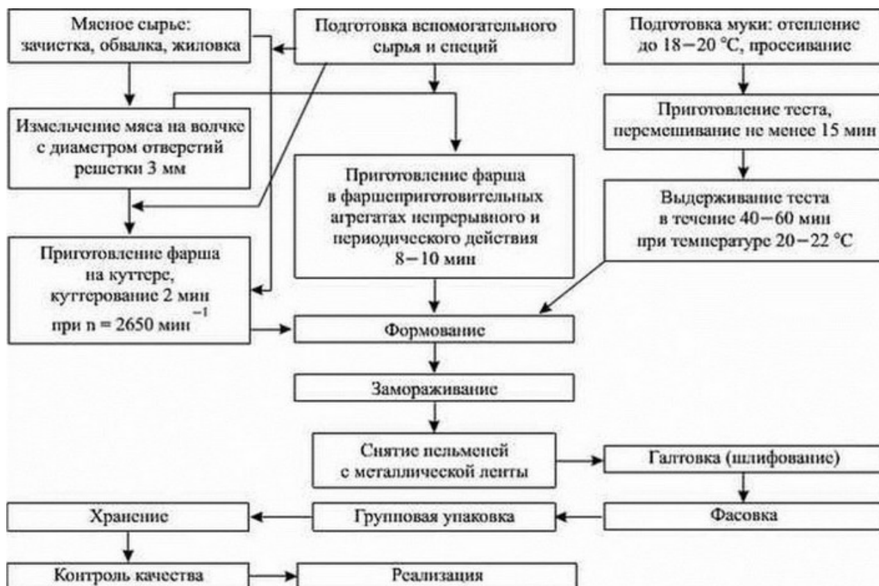
Рис. 1 Технологическая схема производствапельменей
