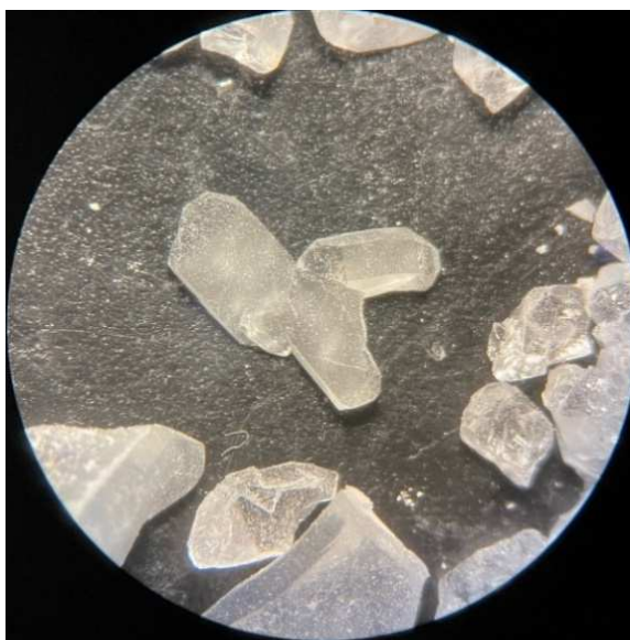
Рис.3.1.2 Сrostок спонтанных кристаллов кварца с двумя головками под бинокулярным микроскопом. Диаметр поля зрения 10 мм.
