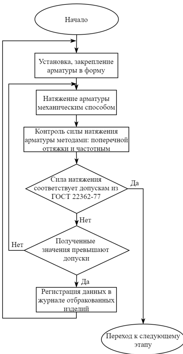
Рисунок 8 – Логическая цепь контроля натяжения арматуры
