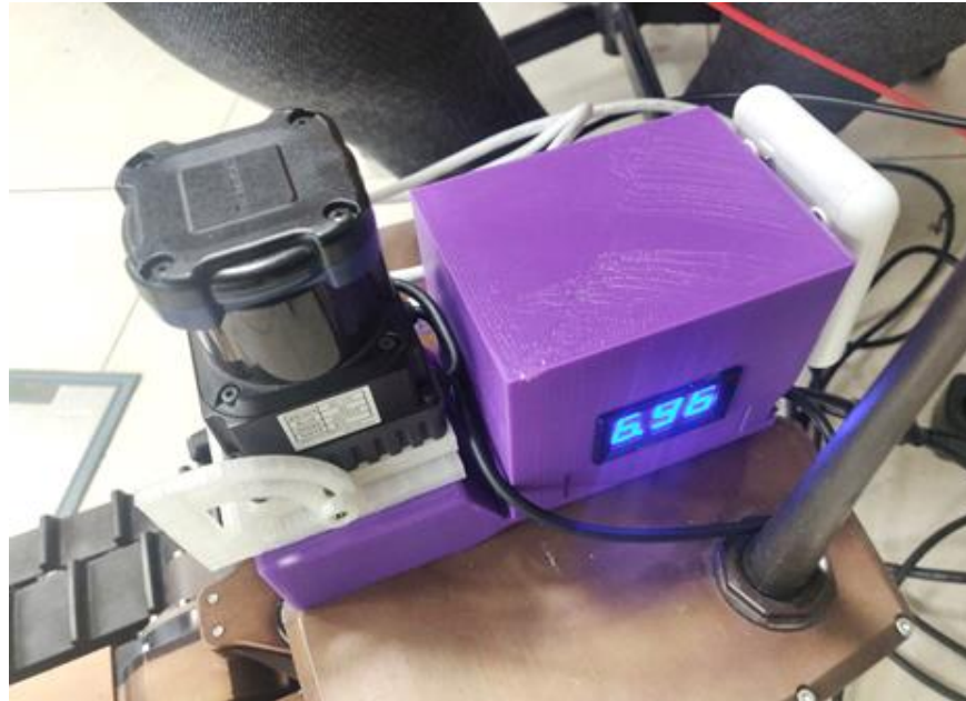
Рисунок 3.2.3.2. Подставка под лазерный дальномер на реальном роботе.
