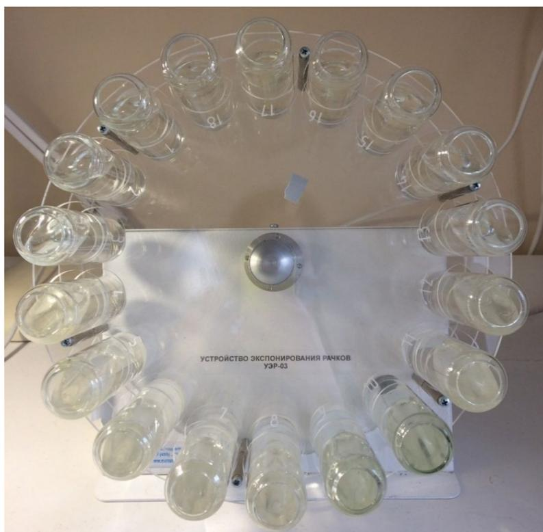
Рис. 7. Процесс вращения экспонируемых проб воды
