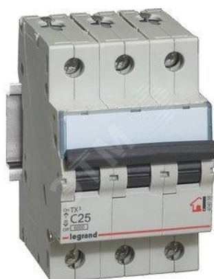
Рисунок 4.30 – Выключатель автоматический трехполюсный 25А С TX3 6кА
